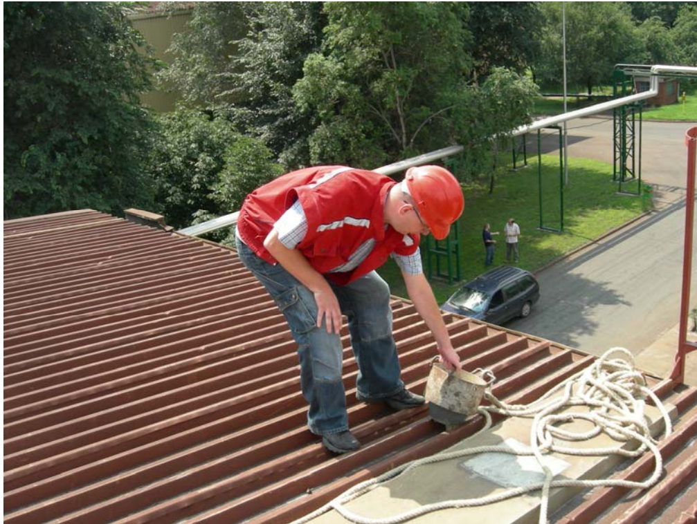
Slika 8: Radioaktivni uložak u olovnom kontejneru
