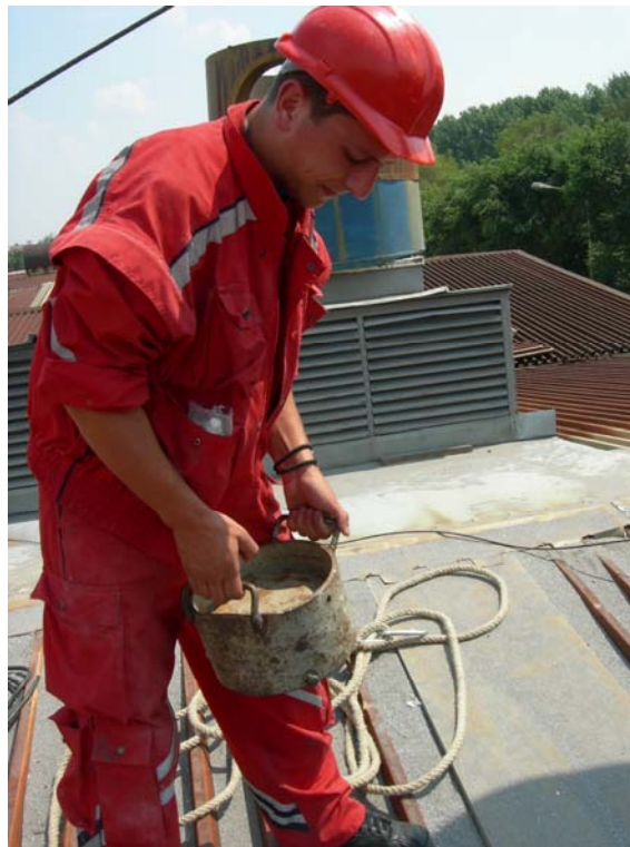
Slika 6: Olovni kontejner za radioaktivni uložak
